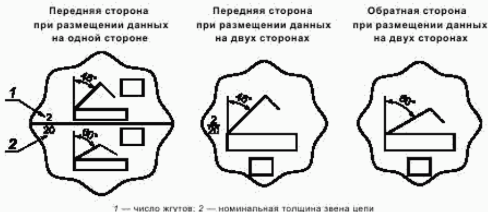
Рисунок D.2 — Ярлыки для маркировки стропальных цепей из нескольких жгутов
